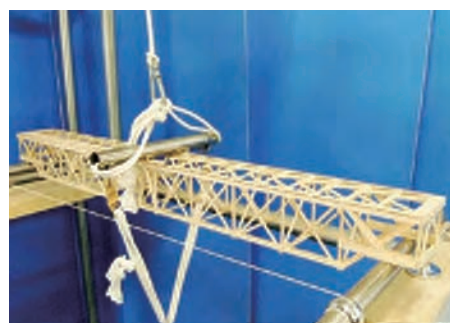
写真2 試作品2の載荷実験
