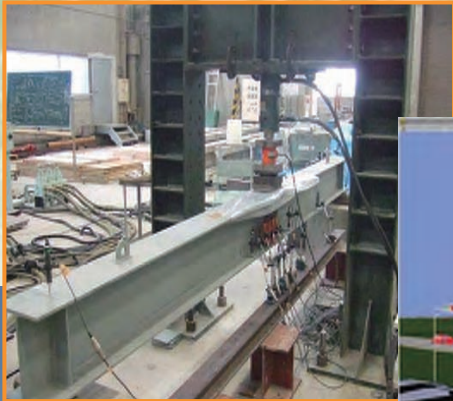
CFRP補強桁の載荷試験
