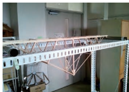
図2 載荷装置への設置状況
